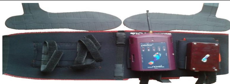
تصویر ۷: کفی‌های دارای حس گر به همراه سیستم پدار
