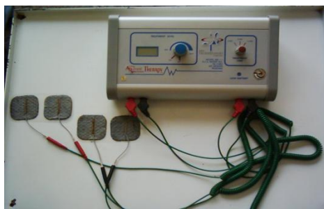
تصویر ۲ دستگاه ای پی اس تراپی مورد استفاده در این تحقیق (APS-MK1) به همراه الکترودهای مربوطه.
