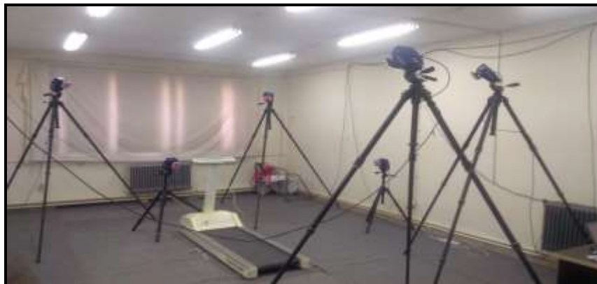
تصویر ۱: محل قرارگیری ۶ دوربین اپتوالکترونیک نسبت به تردمیل
