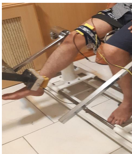
تصویر ۱: صندلی مخصوص طراحی‌شده برای اندازه‌گیری حداکثر گشتاور اکستانسوری زانو
