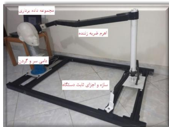
تصویر ۱: دستگاه آزمایش (متشکل از یک دامی سر و گردن، اهرم ضربه‌زننده، پایه دستگاه و مجموعه داده برداری)
