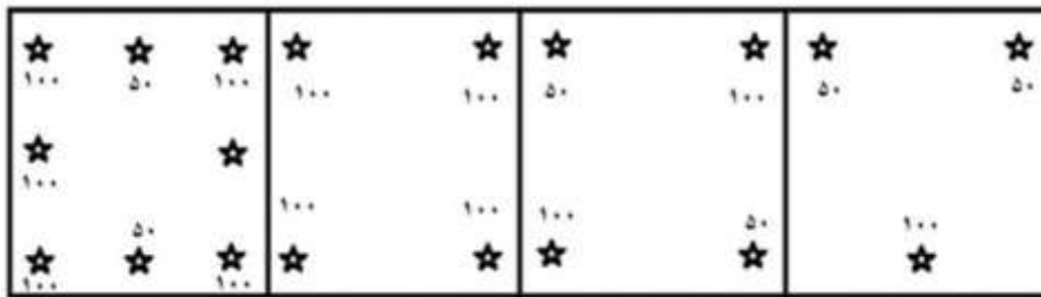
تصویر ۱. نحوه آرایش فنرها زیر سطح، عدد نشان‌دهنده میزان سفتی فنر مورد نظر است
