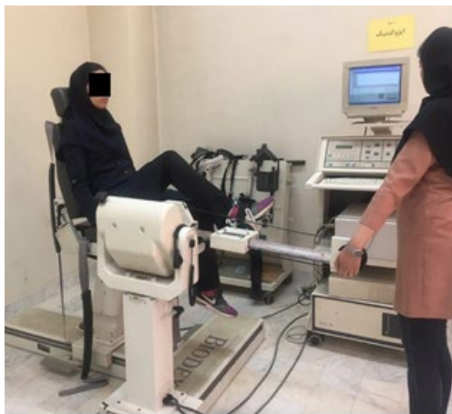
تصویر ۲. الف). انجام آزمون فلکشن و اکستنشن زانو به صورت زنجیره باز حرکتی با دستگاه ایزوکتیک با یو دکس ب). انجام آزمون فلکشن و اکستنشن زانو به صورت زنجیره بسته حرکتی با دستگاه ایزوکتیک با یو دکس
