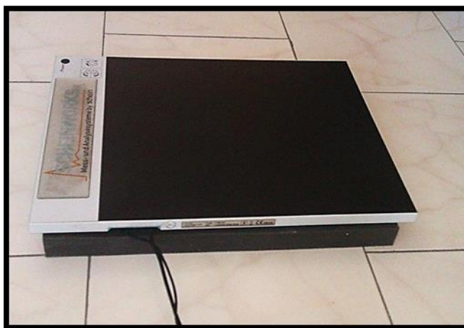
تصویر ۱. دستگاه پدوباروگراف (پلات فورم) مورد استفاده در این مطالعه
