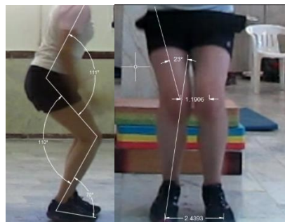
تصویر ۴: نمونه‌ای از فریم‌های جداشده در لحظه برخورد پا با زمین و چگونگی رسم زوایای مورد نظر با نرم‌افزار اتوکد [۱۲]
